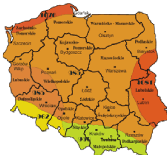
Rysunek 6. Rejonizacja średniorocznych sum promieniowania słonecznego całkowitego padającego na jednostkę powierzchni poziomej w kWh/m 2 /rok. Liczby wskazują całkowite zasoby energii promieniowania słonecznego w ciągu roku dla wskazanych rejonów kraju.
